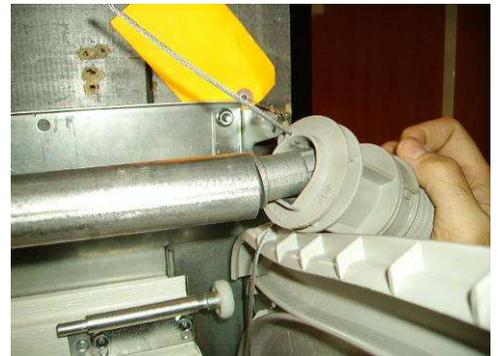
Retirer le tambour du tube permet de ne pas dérégler la longueur des câbles (le tambour pourra rester accroché en haut alors que le tube sera déposé au sol).
